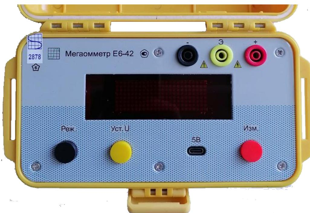
Рисунок 2 – Внешний вид мегаомметра Е6-42
